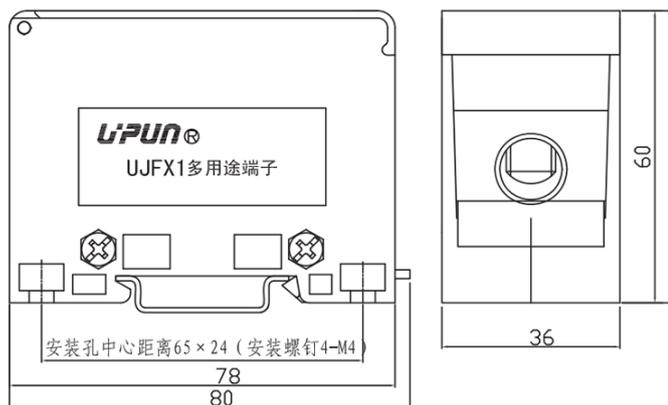
接线端子，额定电压：380V，最大工作电流：232A，接线方式：螺钉连接，连接量：5，高度：60mm，颜色：灰色，安装方式：TH35-7.5、TH35-15、螺钉安装
