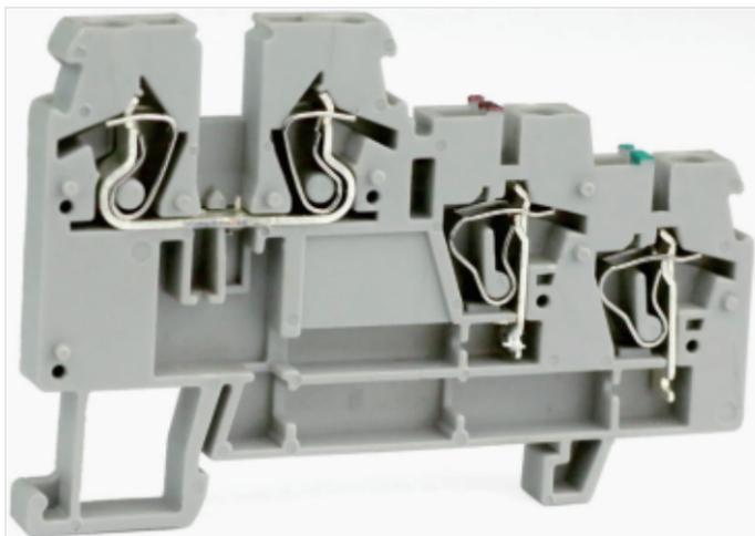
接线端子，额定电压：250V，最大工作电流：18A，接线方式：螺钉连接，连接量：4，压线范围：0.2mm<sup>2</sup> -2.5mm<sup>2</sup>，AWG：24-14，厚度5mm，高度45.3mm，颜色：灰色，安装方式：TH35-7.5、TH35-15、G32-15、G32-18
